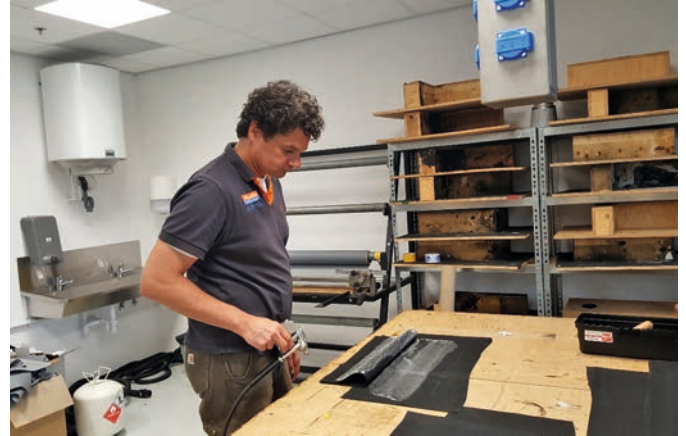
EPDM-training bij Royal. Lijmen kun je verwerken bij een oppervlaktetemperatuur van 5 graden Celsius en hoger.
