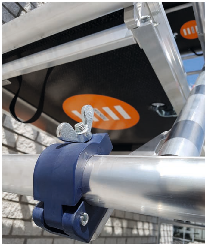
Omdat een rolsteiger zich in de praktijk altijd zal 'zetten' in relatie met de ondergrond, heeft Wienese ervoor gekozen de voorloopleuning uit te voeren met kunststof koppelingen.
