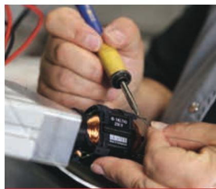
Elke motor voor de Leister-föhns wordt in eigen huis gewikkeld.
